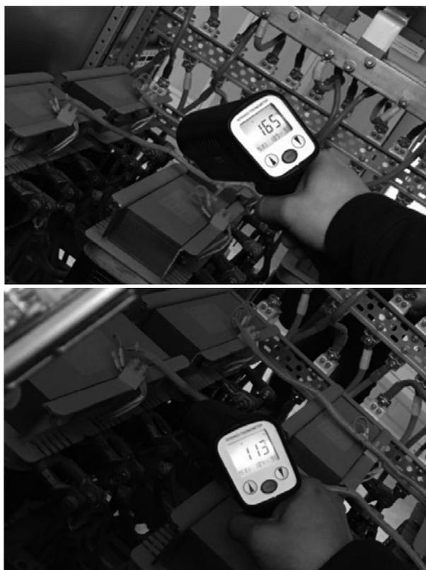
图2 1号电抗器的温度测量结果
