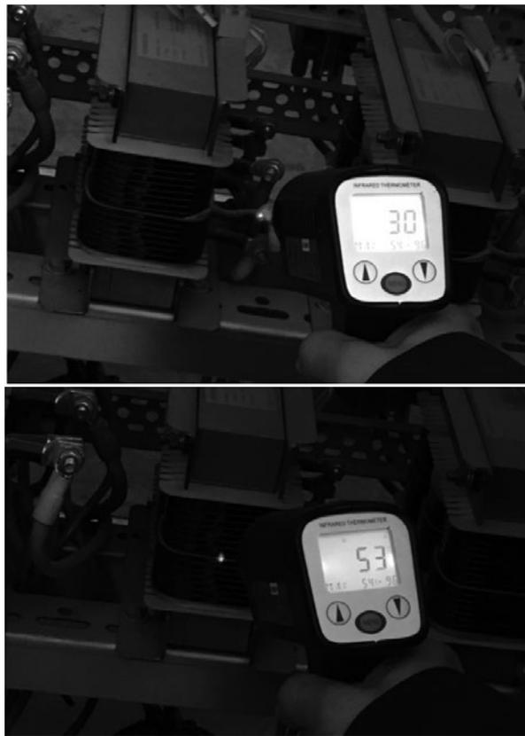
图3 4号电抗器的温度测量结果
