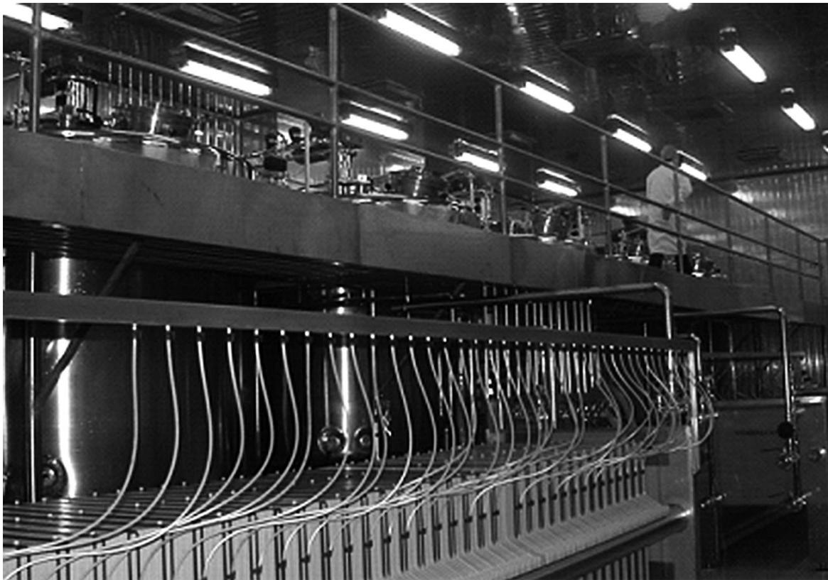
图5 蛋白反应罐和卧式压滤工艺设备
