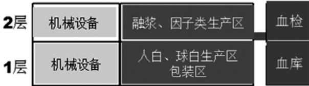
图3 血液制品生产厂房的整体布置方式二
