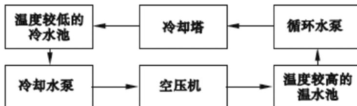
图4 原有空压机组冷却方案流程图
